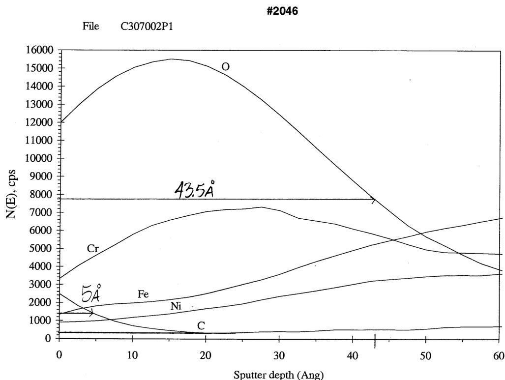
Fig5. AES på ett av Calamo elektroplerat rör av 316L med tjockleken på oxidskiktet 43,5Å.
